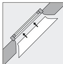
Pose en présence d'une cloison de redressement avec le LSB et le complément LEI.
